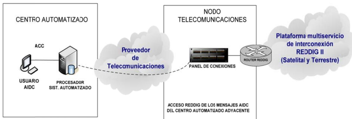
Gráfico 5 - Representación del caso en el cual el nodo de telecomunicaciones de acceso y egreso de mensajes AIDC se encuentra alejado al centro automatizado
